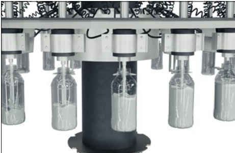
Convoyer et remplir La fonction AntiSlosh est utilisée sur des machines qui convoient et remplissent des contenants de liquides.
