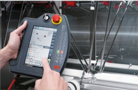
Application Pupitre à poignée pour le pilotage d'une cinématique avec RobotMonitor pour MOVIKIT® Robotics
