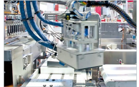
Sammelpacker mit Aufrichter/Verschließer Für präzise Beleimung beim Aufrichten und Verschließen
