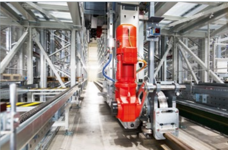
Intralogistik Fahrwerksantrieb als positionsgeführter servo-dynamischer Bremsmotor mit spielarmen Kegelradgetriebe
