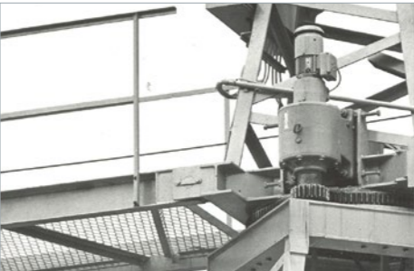
Krane langsam drehender Kranantrieb, netzgeführter Bremsmotor mit Stirnraddoppelgetriebe
