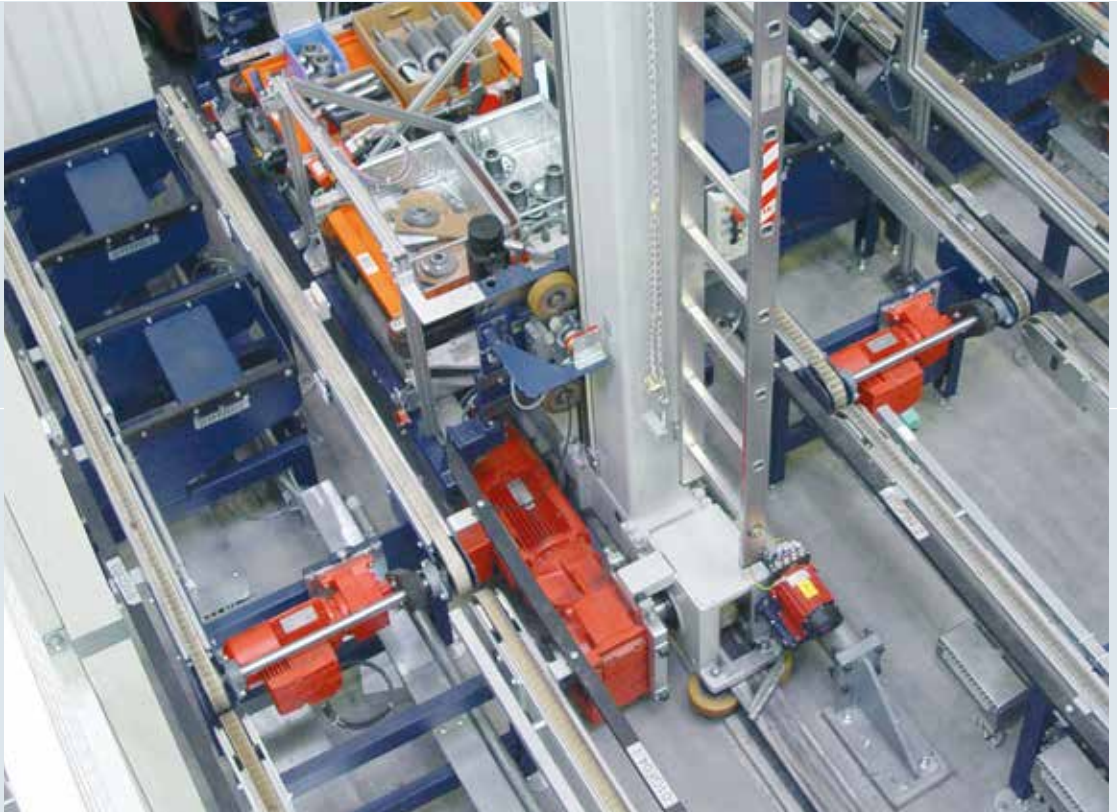
Motorenumstellung IE2 auf IE3 „made by SEW-EURODRIVE“: gleiches Gewicht bei unverändertem Raumbedarf der Motoren.
