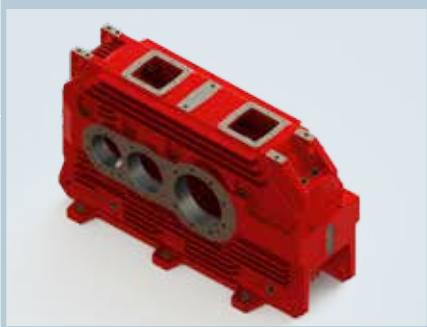
Carter en fonte grise (GG25) avec une surface plus étendue pour une meilleure évacuation de la chaleur
