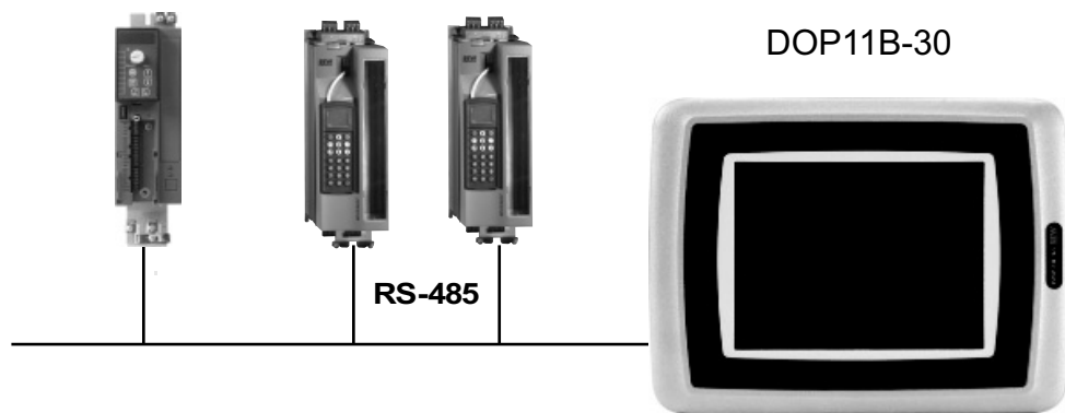
Fig. 12: Conexión entre terminal de usuario y MOVIDRIVE® MDX60B/61B
