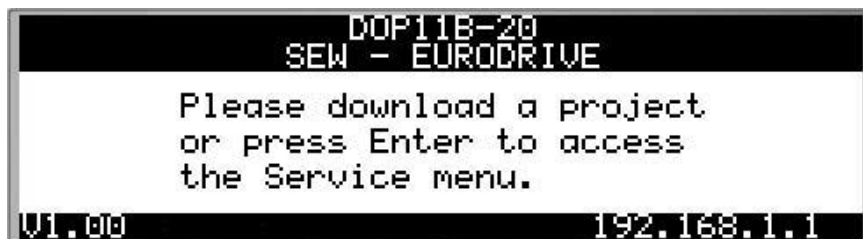
Рис. 14. Начальное сообщение DOP11B-20 после первого включения
