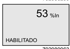
Indicación con el dispositivo de arranque habilitado
