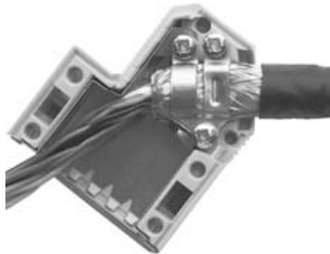
Bild 43: Schirm im Sub-D-Stecker auflegen
