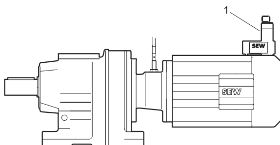
Fig. 3: Motor con control de velocidad con velocímetro NV1
