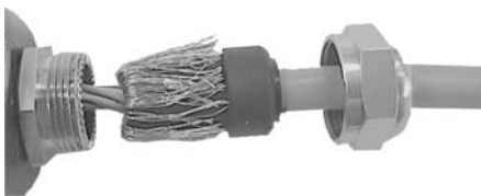
Afbeelding 160: afscherming in de kabelwartel van de encoder aarden
