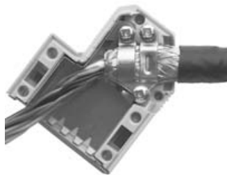
Bild 159: Schirm im Sub-D-Stecker auflegen
