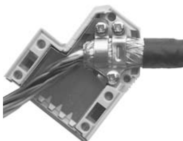
Fig. 30 : Réaliser le blindage au niveau de l'étrier du connecteur Sub D
