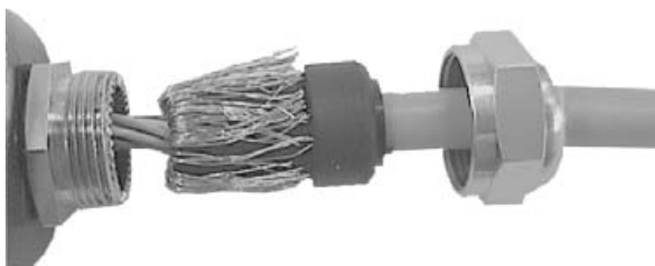
Fig. 31 : Réaliser le blindage au niveau du presse-étoupe du codeur
