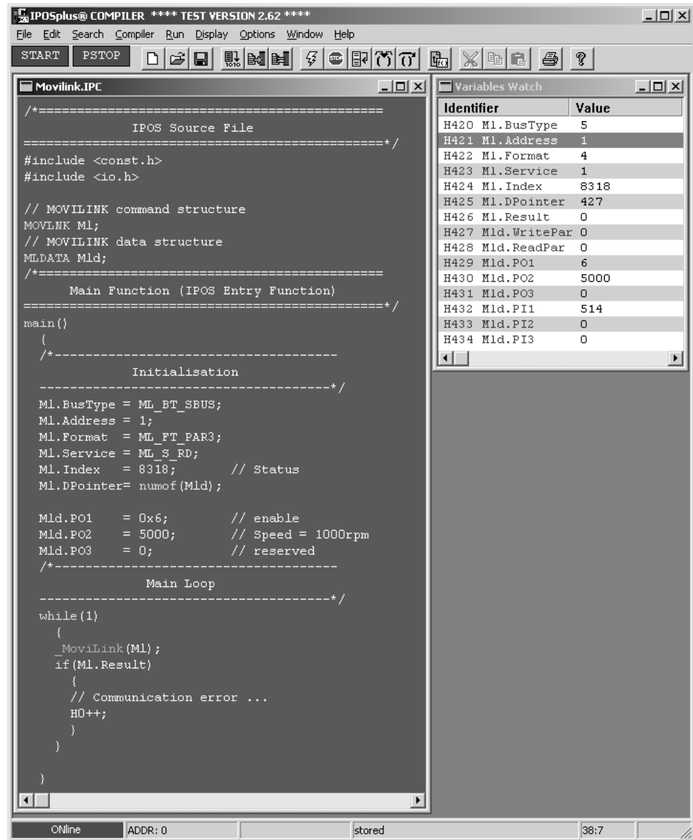
Bild 33: Datenaustausch des Masters über MOVILINK®
