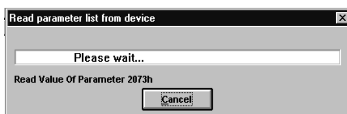
Imagen 19: La herramienta CMD lee los parámetros de la unidad, por lo que la comunicación PCP es correcta.
