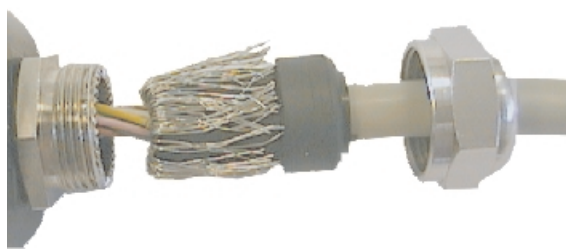
Рис. 18. Подсоединение экрана в резьбовом кабельном соединении датчика
