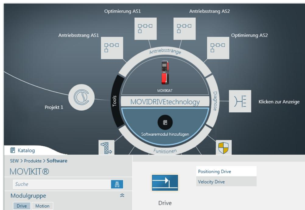
6. Wenn Sie kein MOVIKIT®-Softwaremodul verwenden, müssen Sie die Prozessdatenquelle und die Prozessdaten manuell konfigurieren. Öffnen Sie dazu die Konfiguration des Applikationsumrichters und stellen Sie die Prozessdatenquelle ein.
