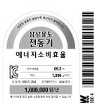
Die Kennzeichnung mit KEL-Etikett oder NON-KEL-Etikett wird beim Passieren des koreanischen Zolls nicht geprüft. Erst am Aufstellungs- und Installationsort entscheidet sich, ob der Antrieb korrekt gekennzeichnet ist und daher eingeschaltet werden darf.
