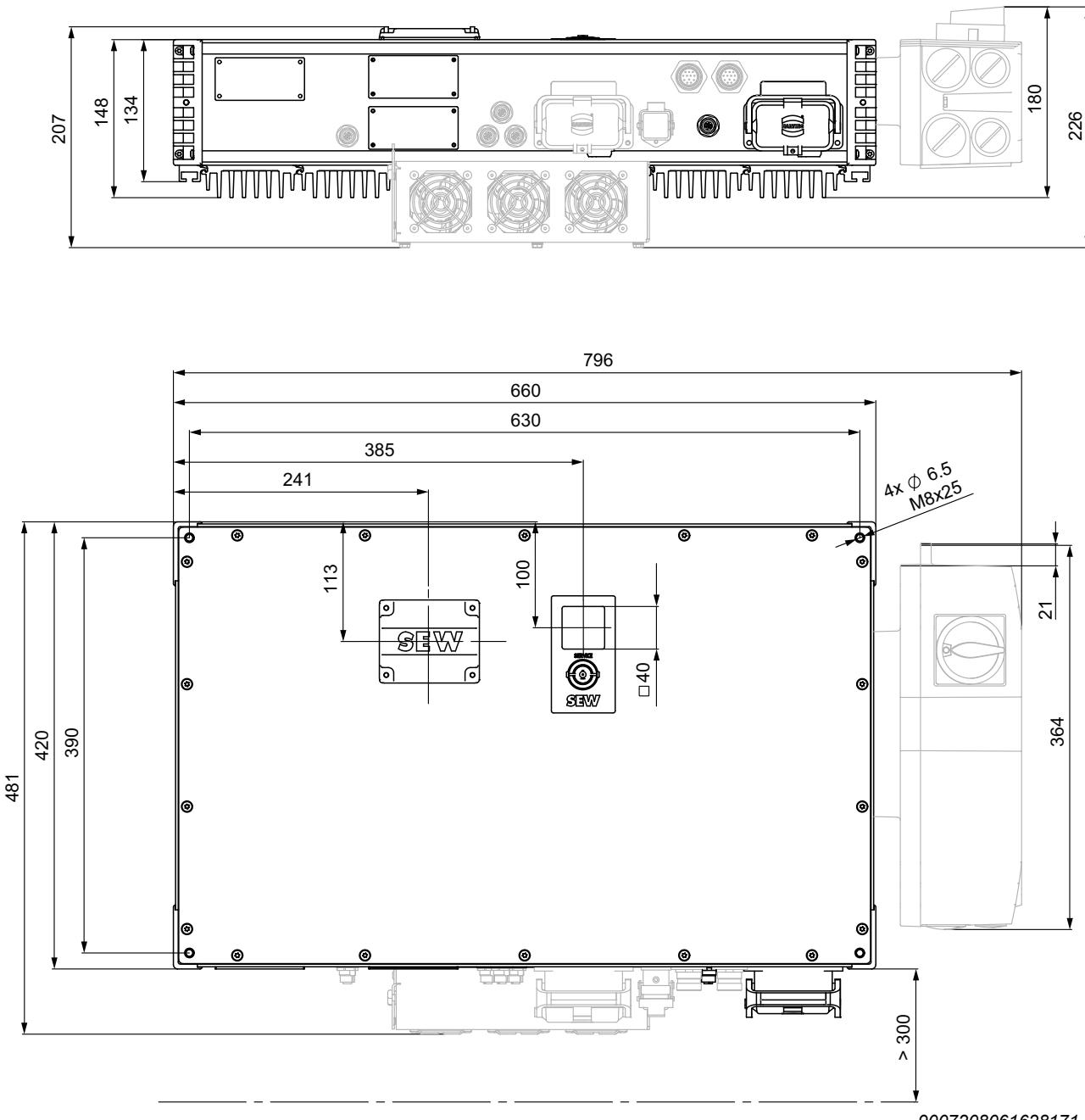
**11.0 kW und 15.0 kW mit Netzrückspeisung (Baugröße 2)**
