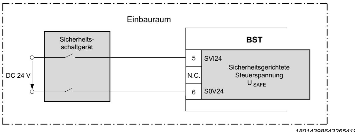
Folgende Abbildung zeigt die Verdrahtung außerhalb eines Einbauraums:
