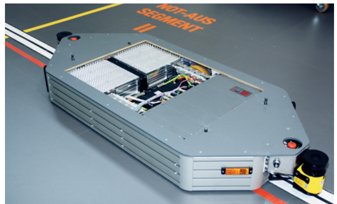
Autonomes Transportfahrzeug mit SuperCapEnergiespeicher
