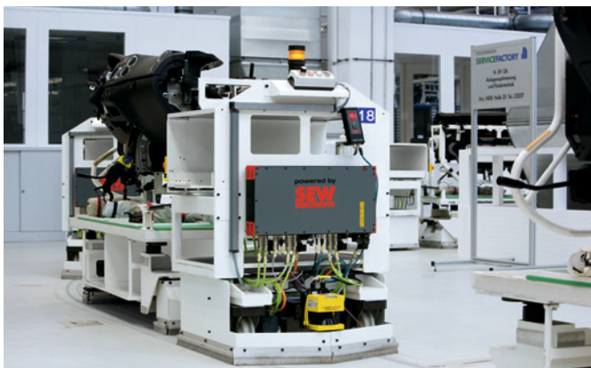
Fahrerloses Transportsystem für die Cockpit-Montage bei VW in Wolfsburg
