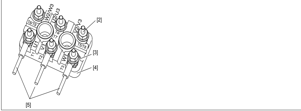
– Bağlantıda klemens köprülerinin yerleşimi
