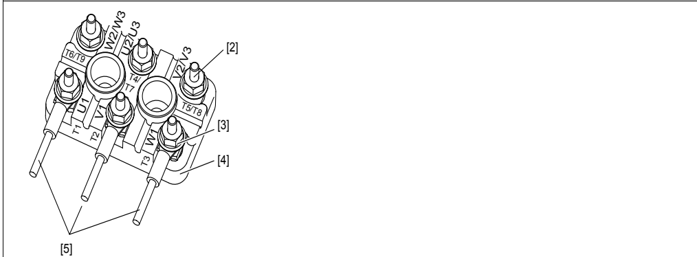
Anordning av byglar vid Y -koppling
