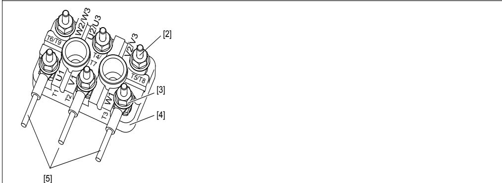
Положение клеммных перемычек при соединении ↘
