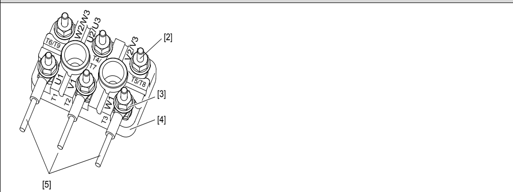
Anordnung der Klemmbrücken bei Y -Schaltung
