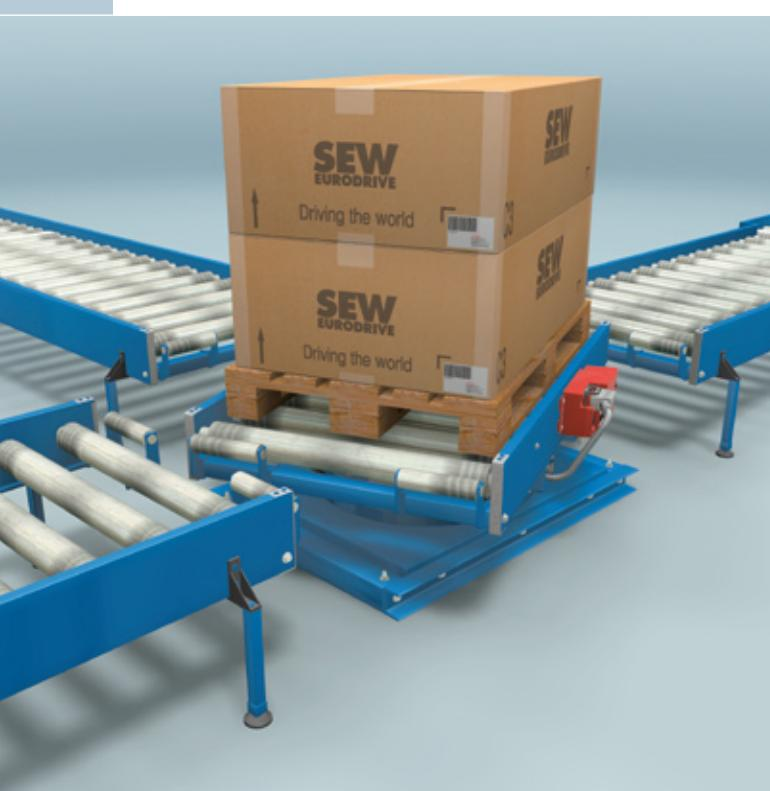
In vielen Anwendungen, wie z. B. im Transportbereich werden Bewegungen mit Hilfe einer Eil-/Schleichgang-Positionierung gesteuert. Diese Lösung ist kostengünstig und bietet gleichzeitig die Möglichkeit, den Einfluss von Störgrößen, wie z. B. den Schlupf beim Positionieren einer Palette auf einer Rollenbahn auszugleichen. Außerdem lassen sich Positionen einfach durch Versetzen eines Sensors einstellen.
