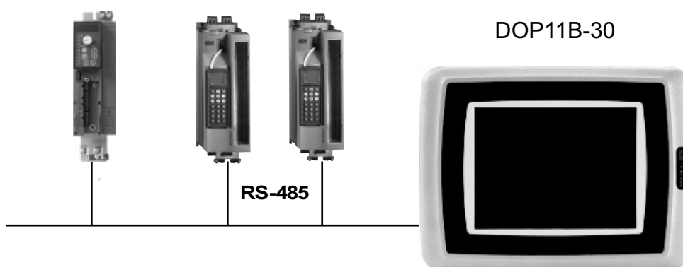
Slika 10: Povezava uporabniškega terminala z enoto MOVIDRIVE® MDX60B/61B
