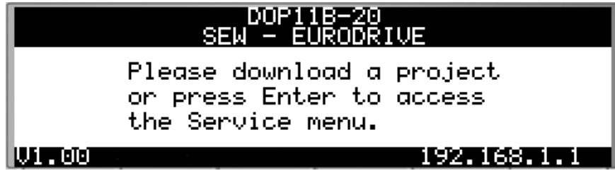
Resim 12: Teslimat durumundaki DOP11B-20 başlama ekranı
