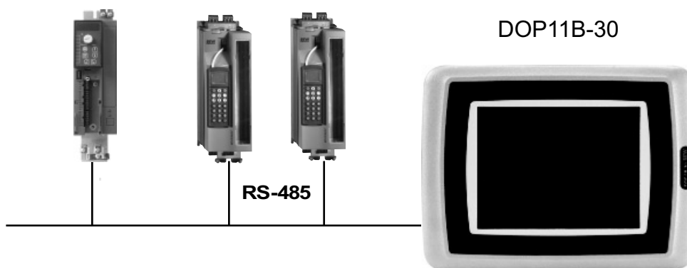
Afbeelding 10: verbinding tussen bedieningspaneel en MOVIDRIVE® MDX60B/61B
