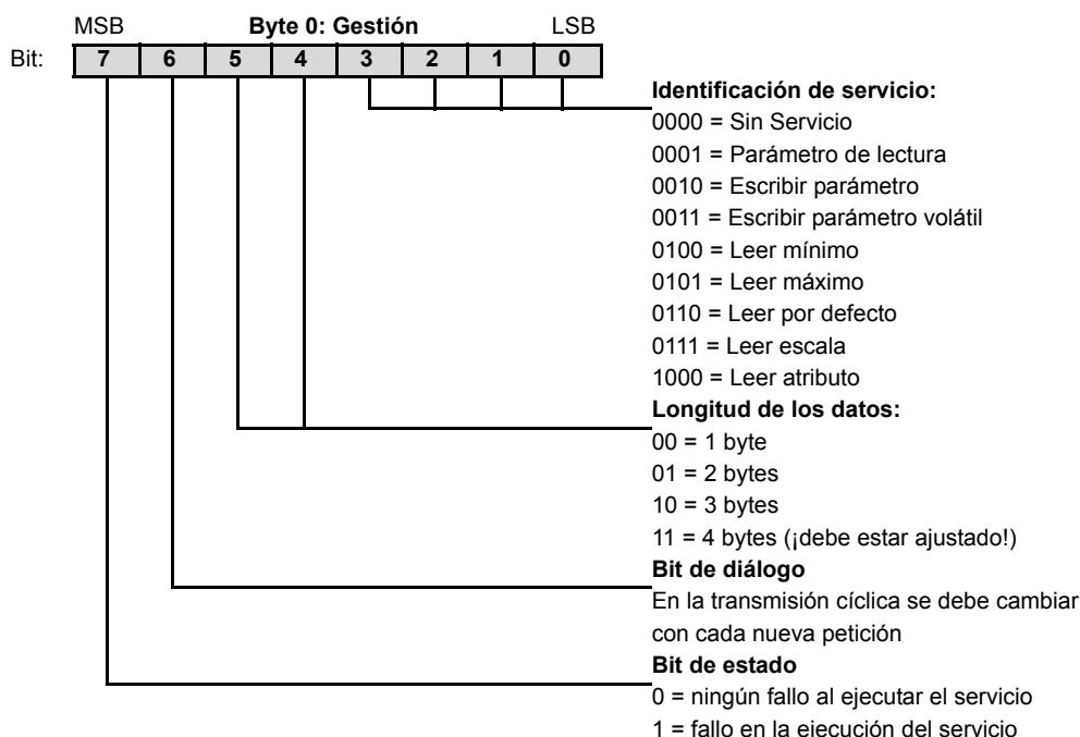
El bit 6 sirve de confirmación entre el control y MQI. Este bit activa en el MQI la ejecución del servicio transmitido.
