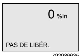
Affichage si le démarreur-moteur progressif n'est pas libéré en mode "Pilotage un moteur"
