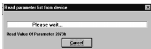
Bild 52: CMD-Tool läser in apparatparametersättningen, dvs. kommunikationen är OK.
