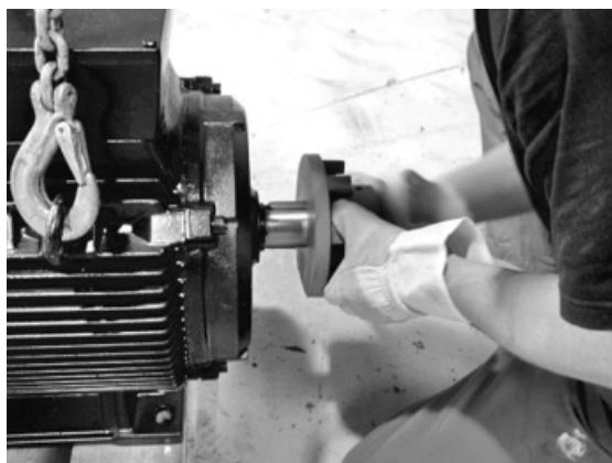
6. Monte el acoplamiento del lado de salida [2] (precalentado) al reductor [1].
