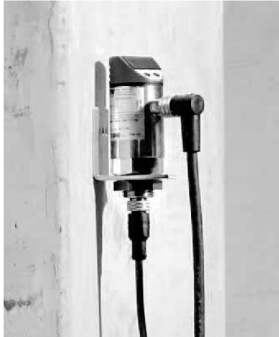
Obr. 1: Konštrukcia diagnostickej jednotky DUO10A
