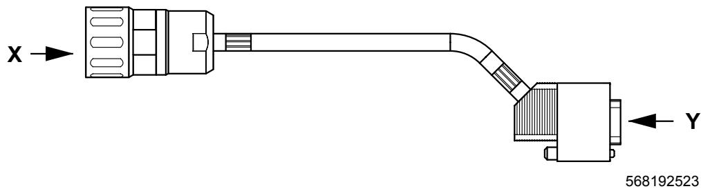
Tipos de cabo de encoder AV1Y / DIP11A/B
