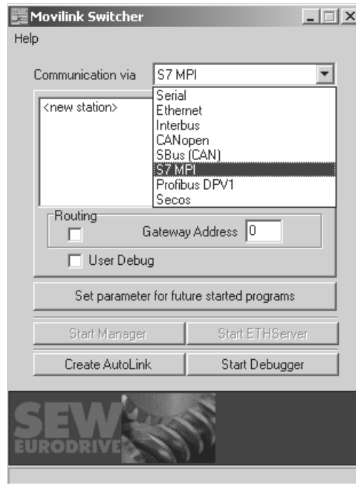
Bild 8: Kommunikationsverbindung über S7-MPI-Schnittstelle umleiten
