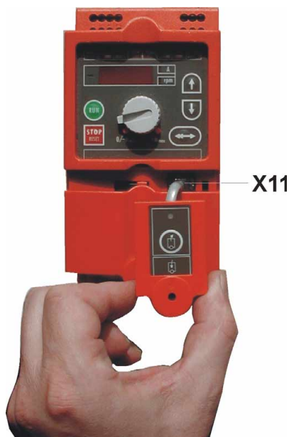
Bild 2: Anschluss an MOVITRAC® 07
