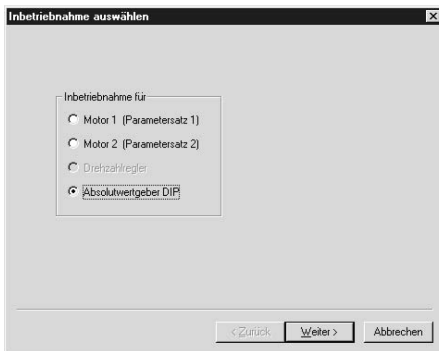
19. ábra Az abszolútérték-jeladó üzembe helyezése
