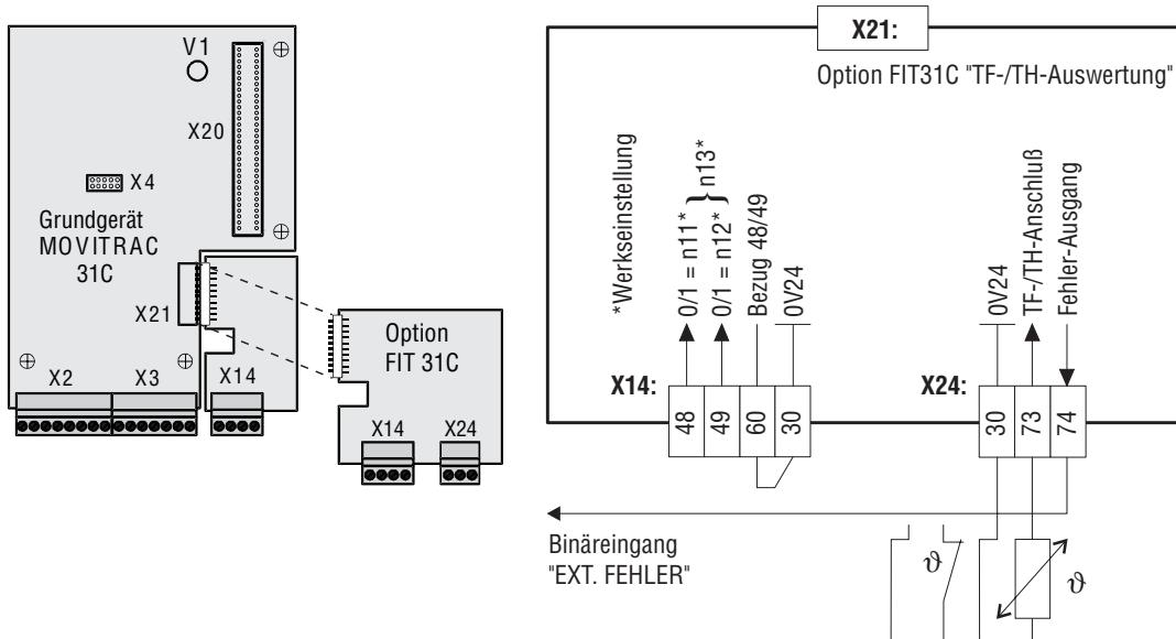
X24:74 (Fehler-Ausgang) ist ein Binärausgang ( $I_{max} = 50 \text{ mA}$ ) mit folgender Spezifikation:
